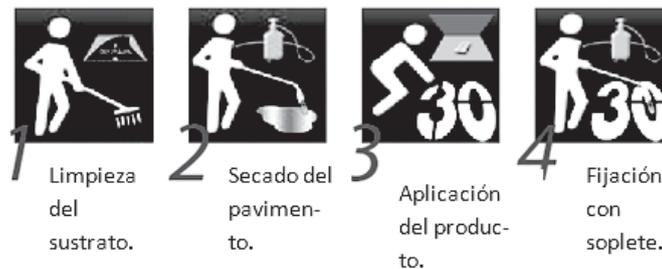
Fig. 02: Proceso constructivo global para la colocación de demarcaciones termoplásticas prefabricadas.
