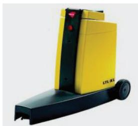
Fig. 03: Retroreflectómetro LTL-XL.
